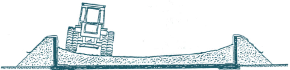
Figuur 5. Een sleufsilos 'hol' vullen, betekent dat de zijkanten goed verdicht worden
